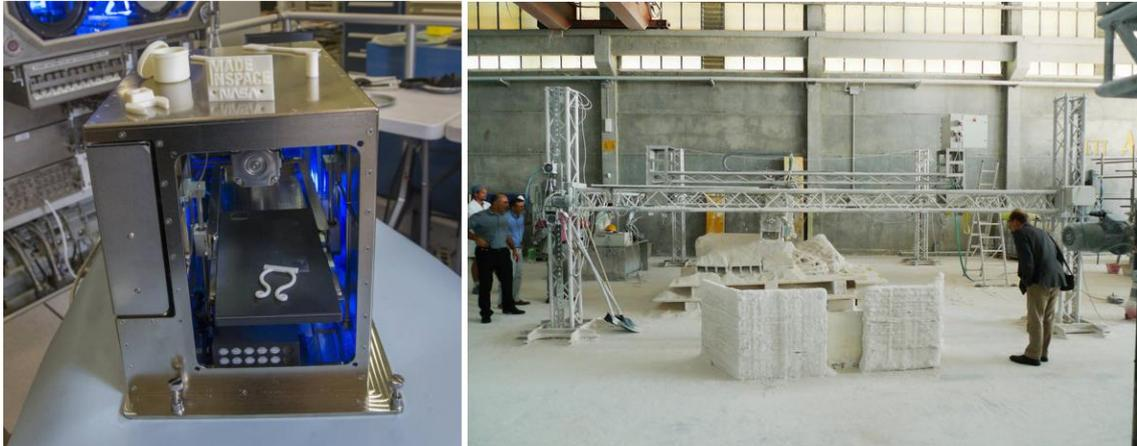
*Izquierda: impresora 3D de la Estación Espacial Internacional. Derecha: la impresora D-Shape para la construcción de una base lunar, con un conjunto de válvulas dispuestas sobre un andamio de 6 m que rocían con un pegamento el material de construcción. Las impresiones 3D se realizan capa a capa en ambos casos.*
