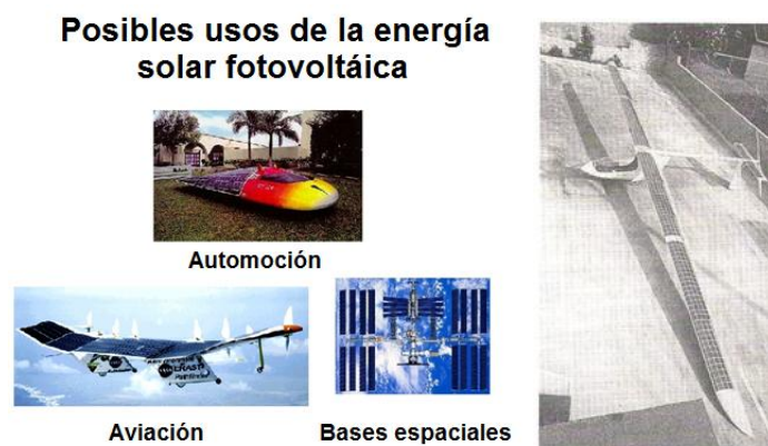
Figura10. Izquierda) Alguno de los diversos usos posibles de la energía eléctrica generada en dispositivos fotovoltaicos. Derecha) Imagen del Sun Seeker (Buscador del Sol), planeador que en 1990 voló 4060 km a través de los Estados Unidos. Las alas estaban recubiertas de módulos fotovoltaicos que, en conjunto, sumaban alrededor de 700 células solares de GaAs, que generaban una potencia de 300 W, con la que se podía cargar una batería de Ni-Cd.
