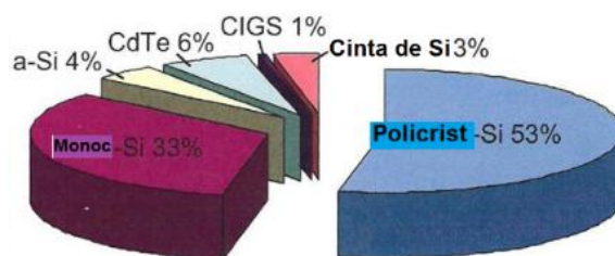
Figura 8. Tanto por ciento de diversos tipos de células solares existentes en el mercado en 2007 (CIGS = células basadas en el material de fórmula \text{CuIn}_x\text{Ga}_{(1-x)}\text{Se}_2 ; a-Si = silicio amorfo).
