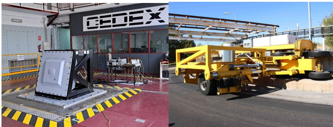
Simulador sísmico (izquierda) y Pista de Ensayos Acelerados de Firmes (derecha)
