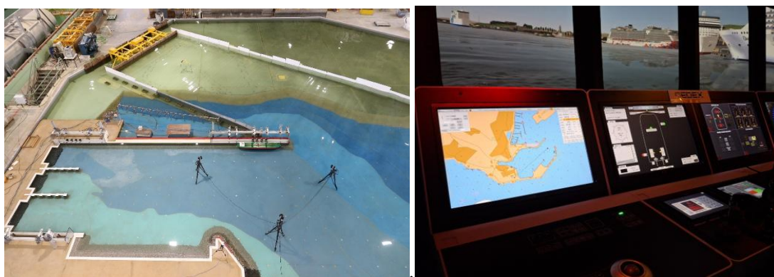
Modelo Físico 3D (1: 100) del puerto de Las Palmas: Ensayos de comportamiento de buques atracados (izquierda), y Simulador de maniobra de buques en tiempo real (derecha, Maniobra de acceso de un ferry al Puerto de Palma, Autoridad Portuaria de Baleares)
