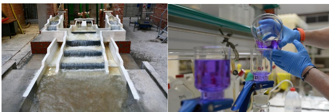
Modelo físico de los órganos de desagüe de la presa del Ebro (izquierda), y Laboratorio de Aplicaciones Isotópicas (derecha)
